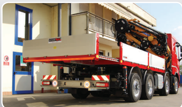
COSTRUZIONE ALLESTIMENTO FISSO + GRU • pianale allungabile idraulico
