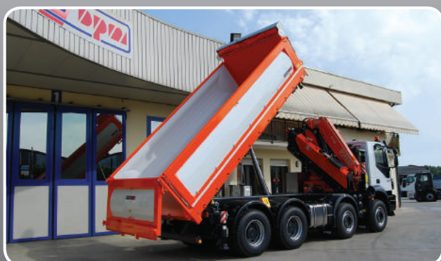
COSTRUZIONE ALLESTIMENTO RIBALTABILE + GRU • sponde semitonde in acciaio antiusura, • piantoni rinforzati mod. VIP
