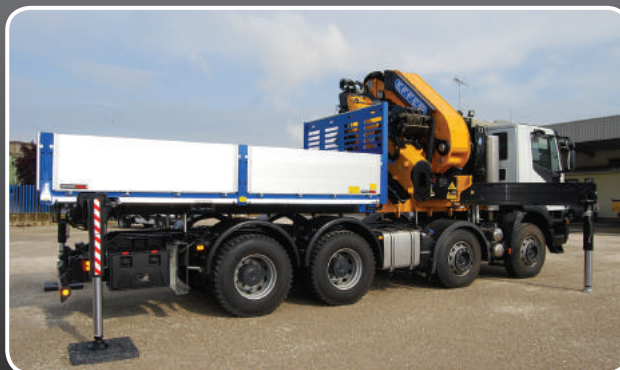
COSTRUZ. ALLESTIM. IMPIAN. SCARRABILE A TRASCINAMEN. IDRAULICO • cassone fisso + gru
