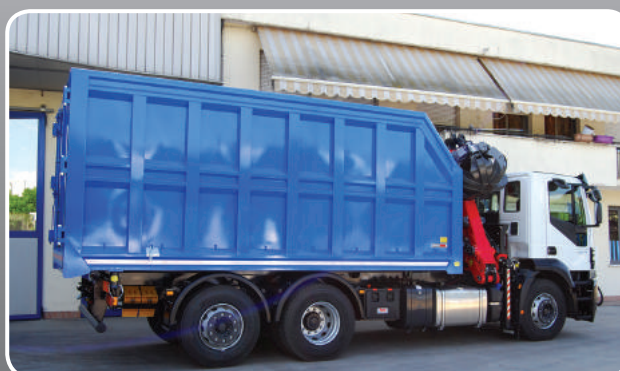
COSTRUZIONE ALLESTIMENTO VASCA RIBALTABILE + CARICATORE • sponde e porte posteriori in acciaio antiusura
