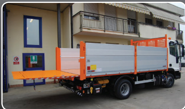
COSTRUZIONE ALLESTIMENTO RIBALTABILE BILATERALE • sponda caricatrice posteriore a battente
