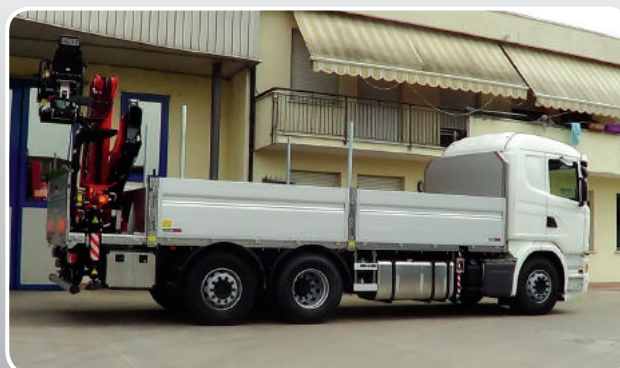
COSTRUZIONE ALLESTIMENTO FISSO + GRU SCARRABILE • banchine e piantoni in acciaio inox fiore
